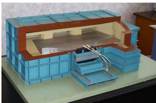
Рисунок 1.1 – Миксер с установкой индуктора в боковой стенке
