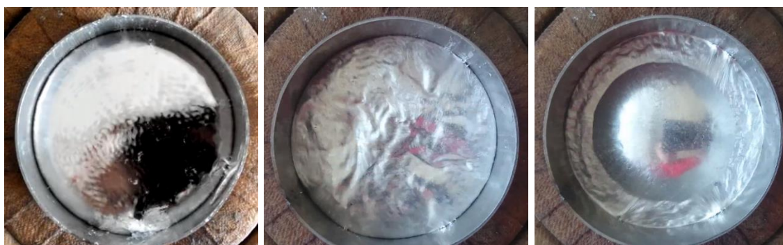
Рисунок 3.3 – Картины движения металла в тигле при различном питании дополнительной катушки: а) 0 А; б) 5 А сдвиг +90^\circ ; в) 5 А сдвиг -90^\circ
