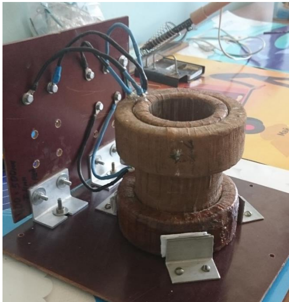
Рисунок 3.1 – Физическая модель индукционной тигельной печи с МГД-вращателем
