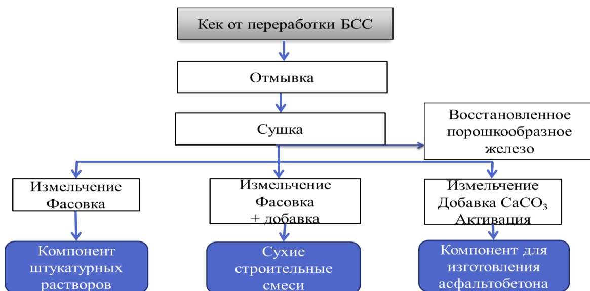
Рисунок 11– Предлагаемая схема переработки гипсогидратного кека
