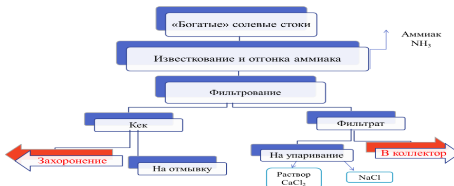
Рисунок 10 – Существующая схема переработки «богатых» солевых стоков
