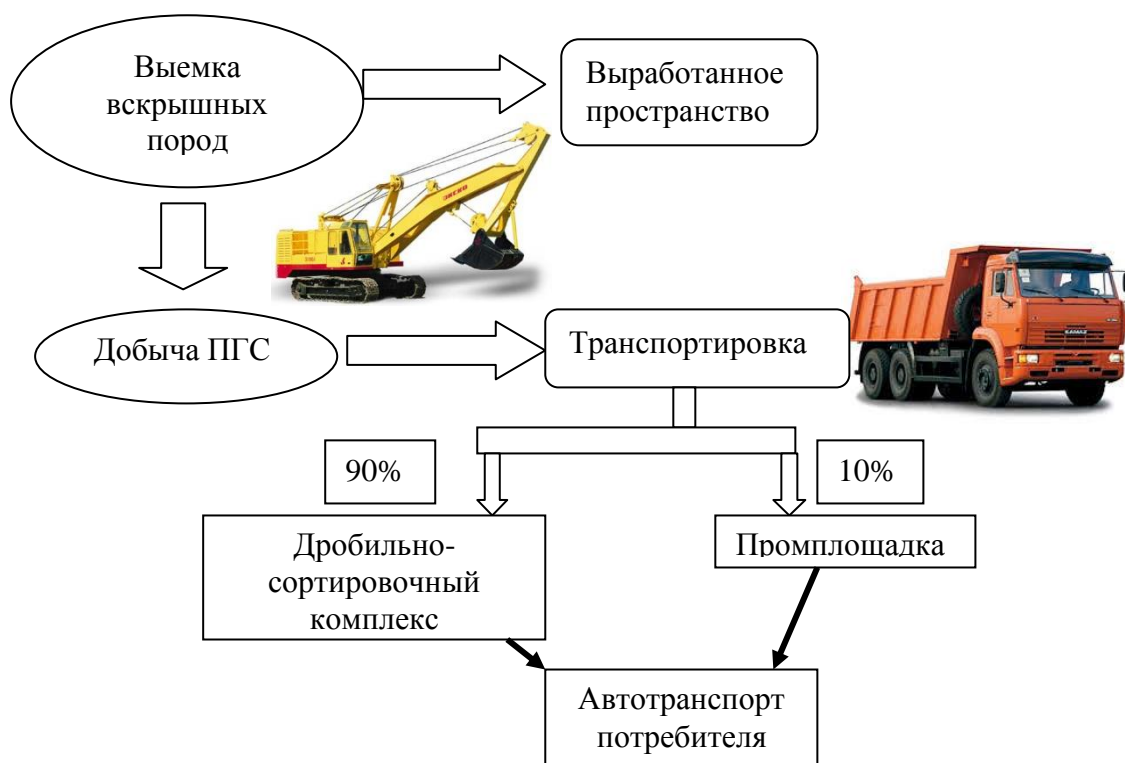
Рисунок 8 - Технологическая схема производства щебня
