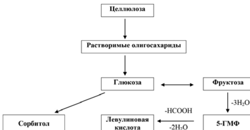
Рис. 2. Схема превращения МКЦ в процессе ее гидрирования в воде в присутствии Ni-содержащих катализаторов
