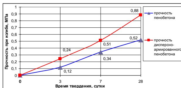
Рис. 10. Предел прочности при изгибе: а - плотностью D 400; б - плотностью D 800
