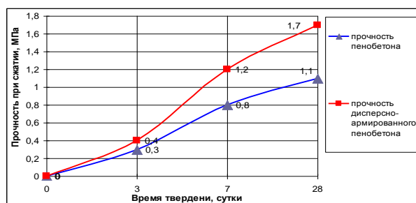
Рис. 9. Предел прочности при сжатии: а - плотностью D 400; б - плотностью D 800
