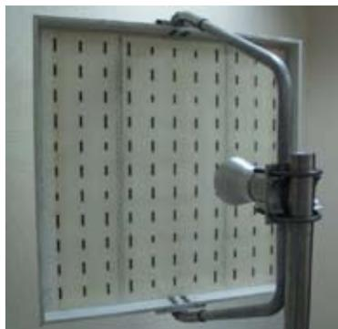
Рис. 12. Фотография экспериментальной ПАР
