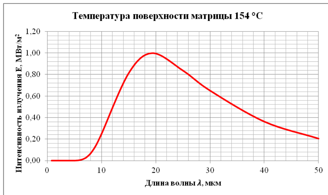
Рис.2 – Распределение интенсивности излучения на инфракрасном участке спектра в варианте с охлаждением матрицы
