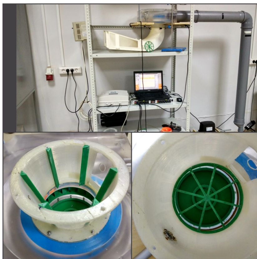
Рис.1 – Общий вид макета гидроагрегата и крестовины с ребрами
