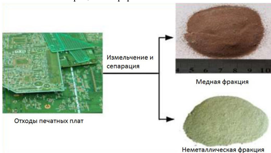
Рис.1 – Механическая переработка печатных плат
