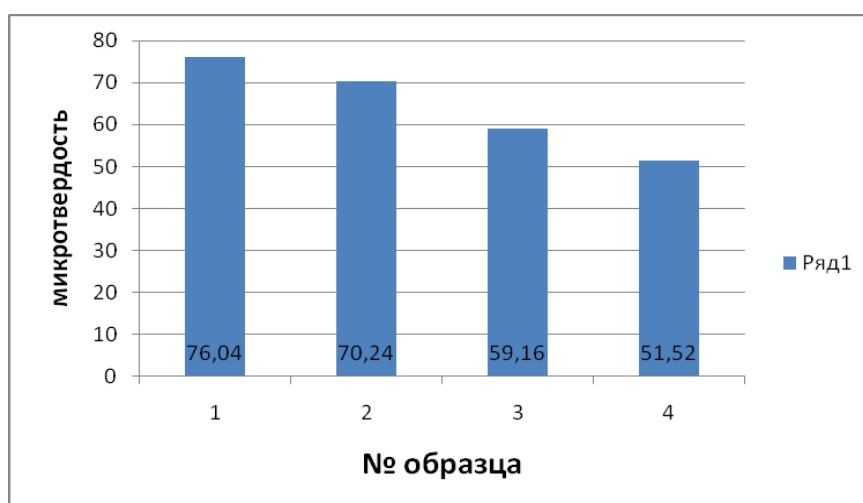
Рис.2 - Гистограмма микротвердости поперечных образцов
