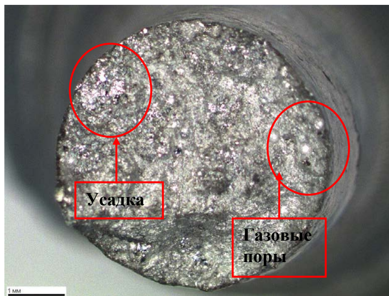
Рис.2 - Фрактура излома образца, после испытания на растяжение
