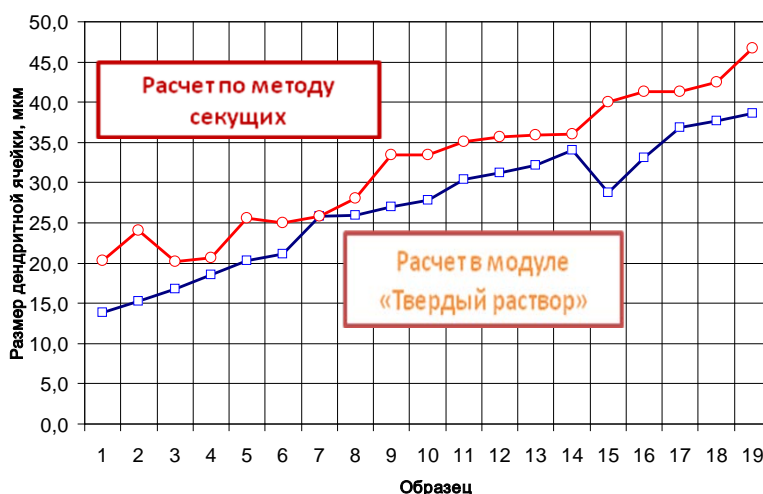
Рис.3 – Результаты измерений сплава АК12пч методом секущих и по модулю «твердый раствор»
