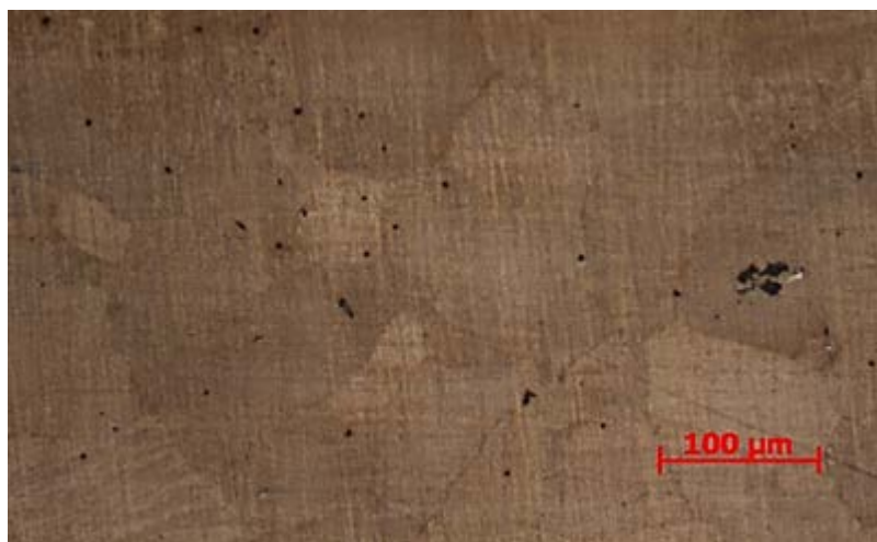
Рис.2 – Микроструктура стали 110Г13Л после закалки
