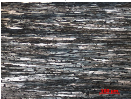
Рис.2 – Микроструктура деформированных полуфабрикатов: а, б – сплав 5, в, г – сплав 6, д, е – сплав 7, ж, з – сплав 8; а, в, д, ж – с оксидированием (×200), б, г, е, з – без оксидирования (×500)
