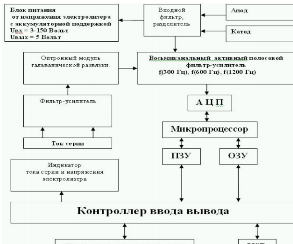
Рис.3- Структурная схема автономного блока съема и передачи информации
