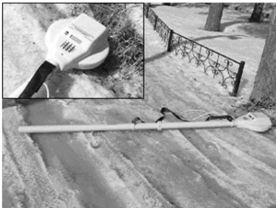
Рис.2 – Наземный переносной аппаратно-программный комплекс «NEMFIS»
