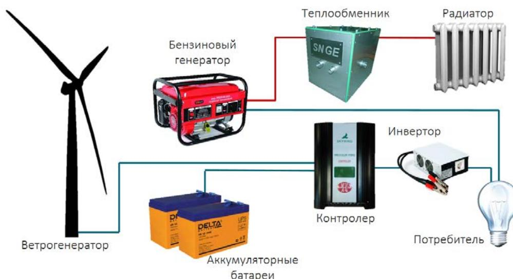
**Рис.1 - Структурная схема ветро-бензиновой установки**
