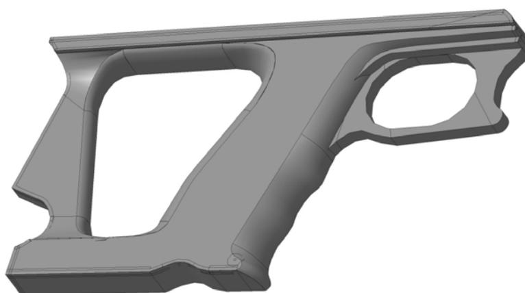
*Рис. 2 - Трехмерная модель сложнопрофильной пистолетной рукоятки*
