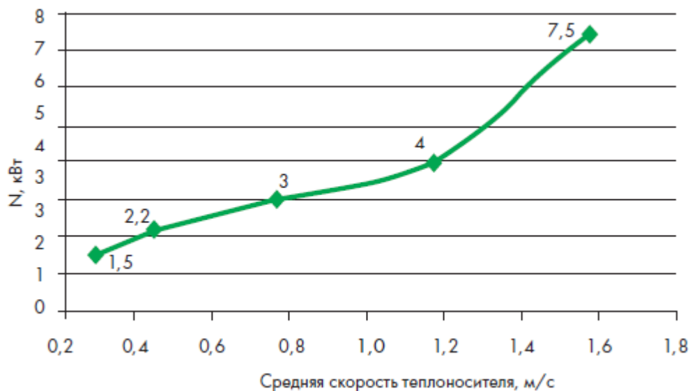
Рисунок 1. Зависимость электрической мощности насосов от скорости теплоносителя
