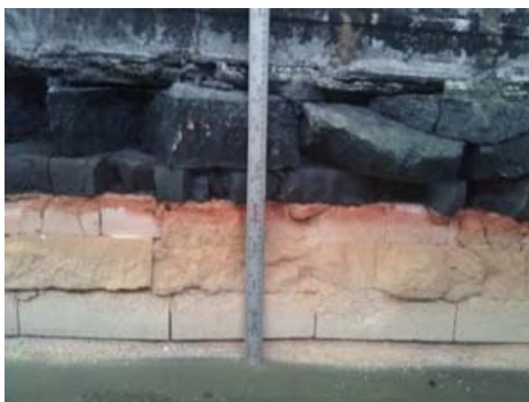
Рис. 10. Состояние футеровочных материалов в цоколе катода С-175 спустя 2310 сут службы
