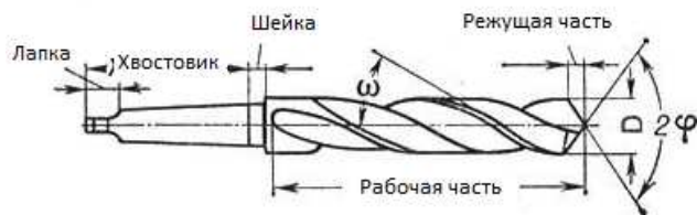
Рисунок 2 – Параметры сверла
