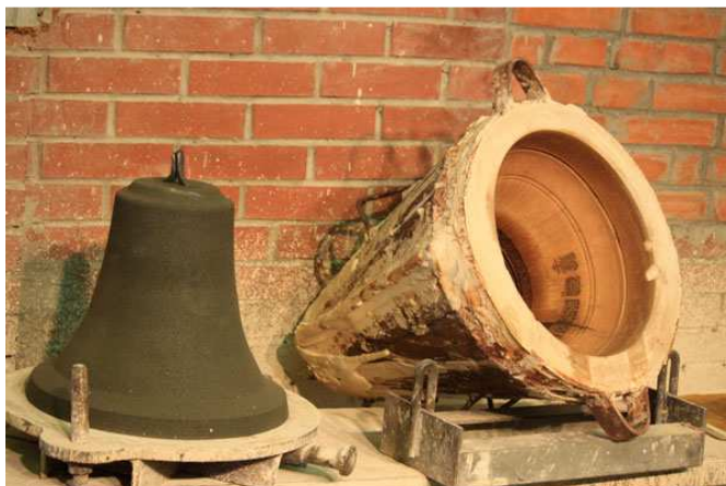
Рисунок 3 – Болван и кожух (литье в керамику)
