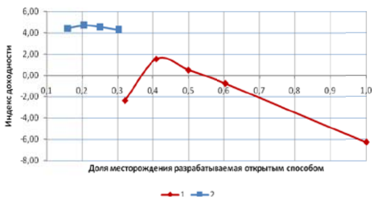
Рис. 5. Зависимость индекса доходности инвестиций от доли месторождения, разрабатываемого карьером при комбинированном способе: 1 и 2 – при круглогодичной и сезонной работе карьера
