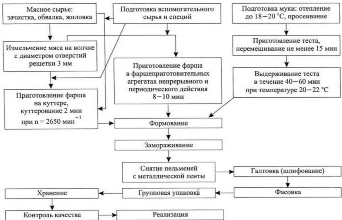
Рисунок 4 Технологическая схема производства рубленых замороженных мясных полуфабрикатов
