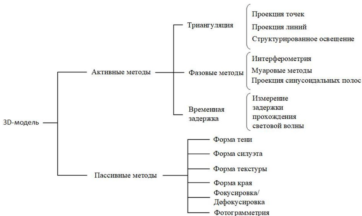
Рисунок 1 – Разнообразие бесконтактных методов определения 3D-профиля, использующих световое освещение [1]
