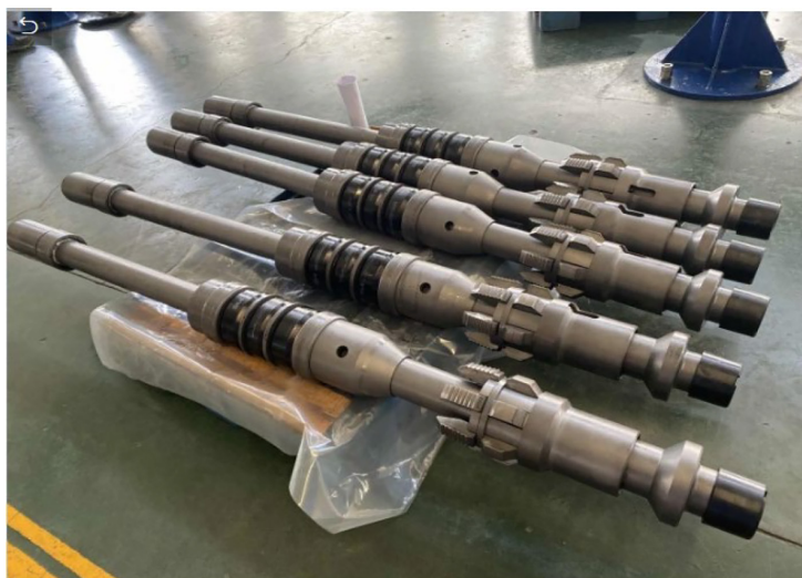
Рис. 1. Пакер, применяемый на месторождении Суэдия (Сирия)
