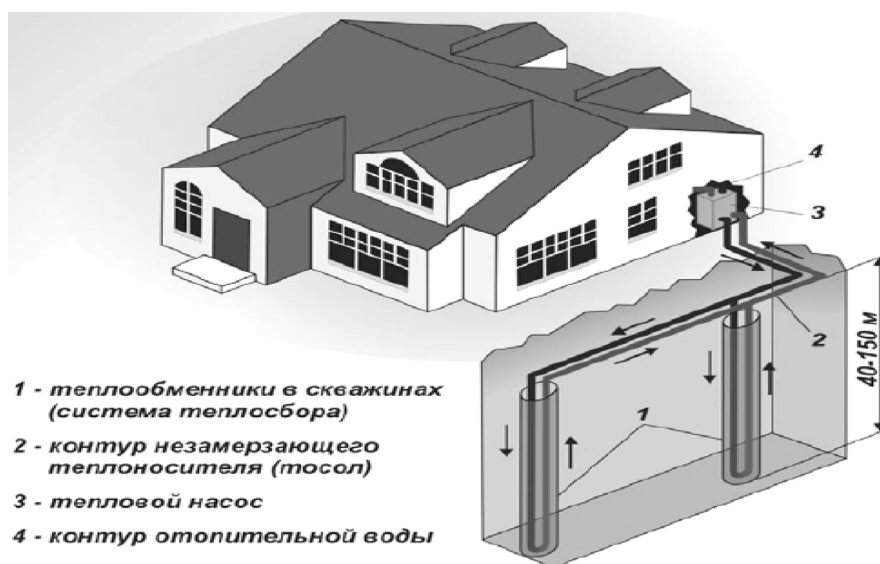
Рис. 7. Принципиальная схема автономной системы теплоснабжения на основе теплонасосной станции с закрытым контуром и вертикальными грунтовыми теплообменниками
