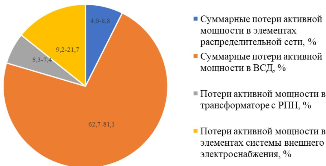
Рисунок 7 – Структура потерь активной мощности в системе электроснабжения промышленного предприятия с активными элементами
