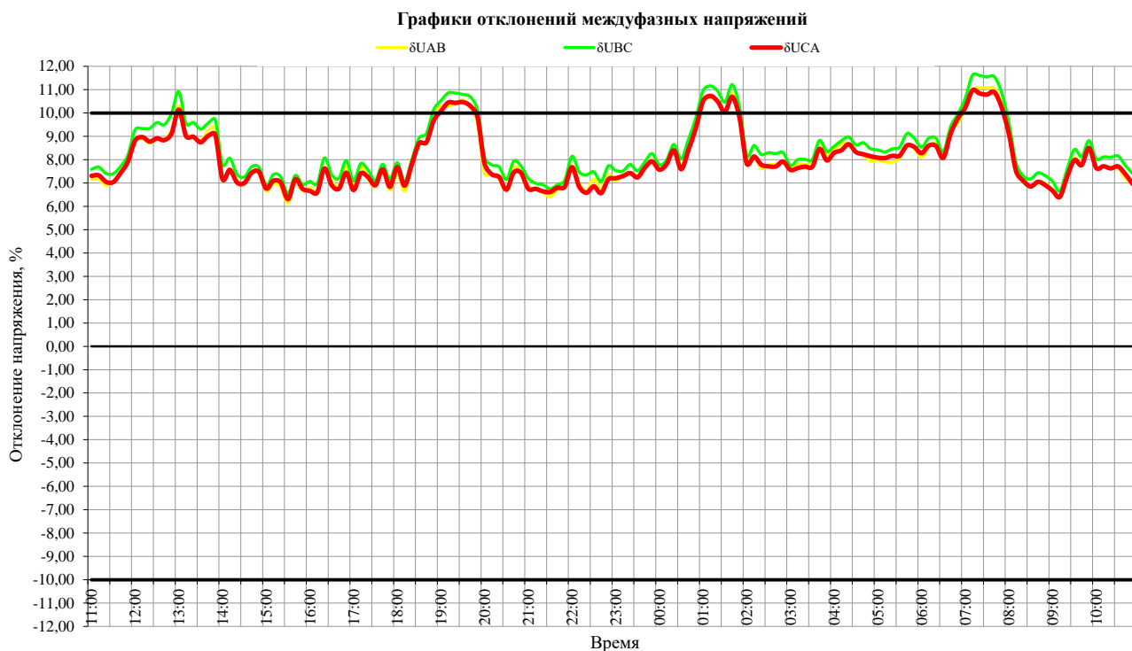
Рисунок 3.2 – График отклонений междуфазных напряжений на II СШ
