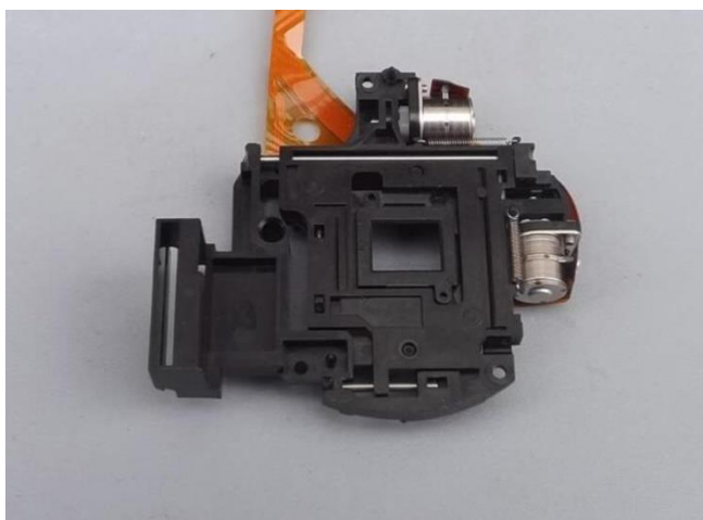
Рисунок 25 – Макет детали фотоаппарата, используемой в качестве передвижного столика
