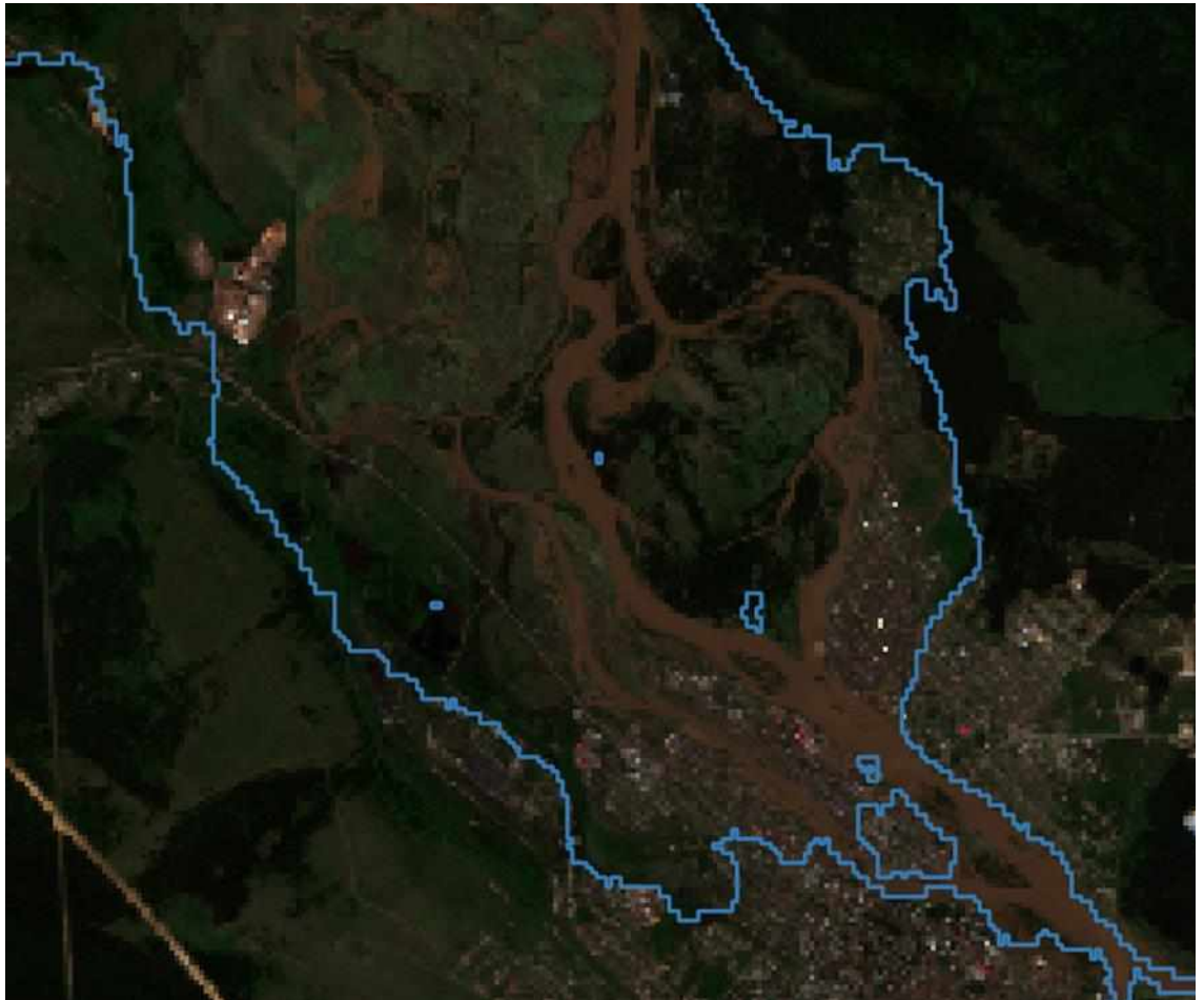
Рисунок 21 – контур зоны затопления на уровне 405 метра г. Нижнеудинск
