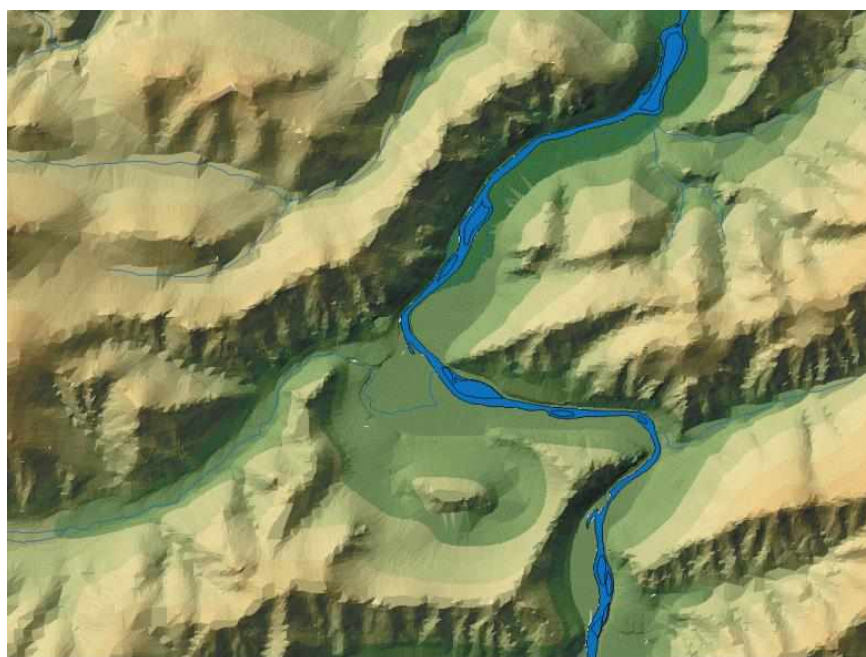
Рисунок 2 – Фрагмент ЦМР Июсского природного парка (Хакасия), представленной в виде гипсометрической карты с теневой отмывкой рельефа
