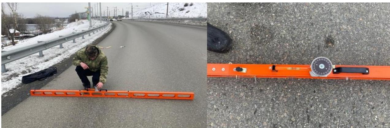
Рисунок 10 – Процесс измерения наклона дорожного полотна
