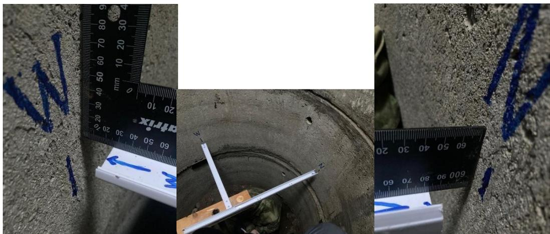
Рисунок 9 - Процесс измерения зазора
