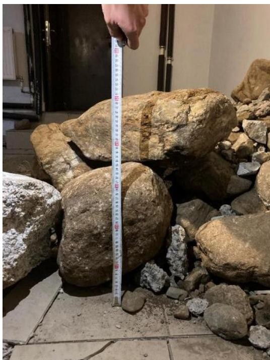
Рисунок 22– Разделённые глыбы, извлечённые из шурфа №1
