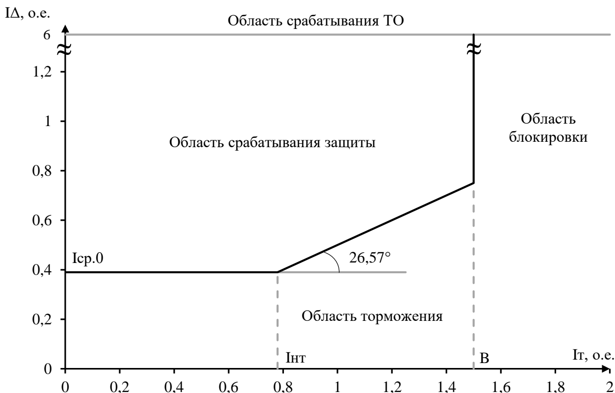
Рисунок 5.2 – Характеристика срабатывания продольной дифференциальной защиты генератора
