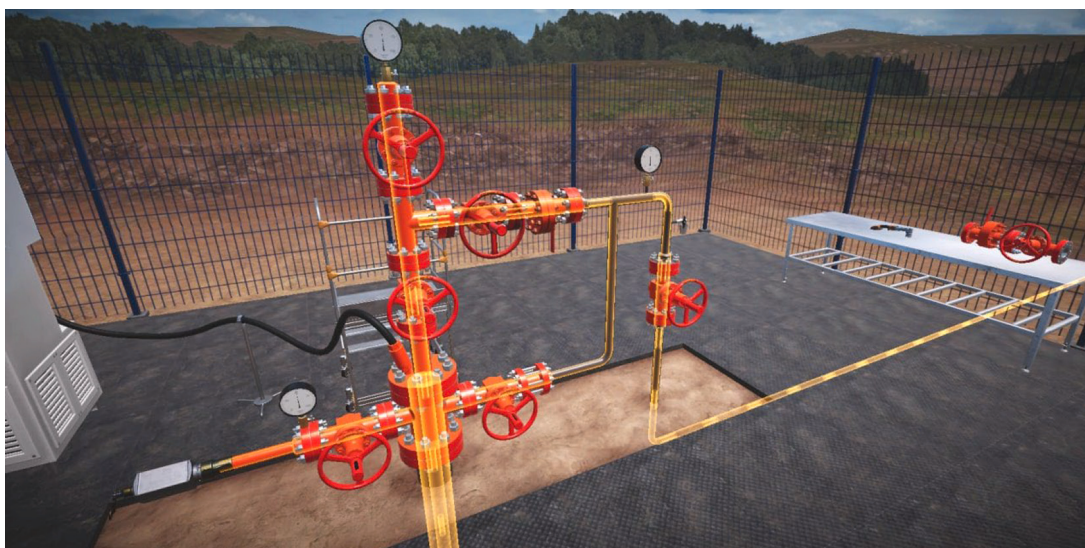
Рис. 4. Демонстрация содержимого трубного пространства ФА Fig. 4. Demonstration of the contents of the pipe space of fountain fittings
