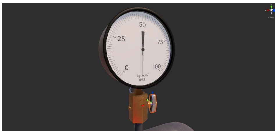
Рис. 8. Манометр с вентилем для снижения давления Fig. 8. Pressure gauge with pressure reducing valve
