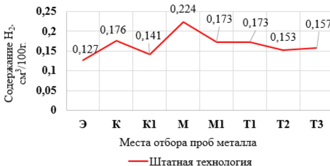
Рисунок 4 - Динамика изменения концентрации водорода в жидком металле на основных этапах литейного передела изготовления мелкой чушки из алюминиевых сплавов:
