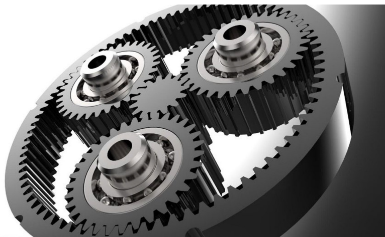
Рис. 7. Планетарный редуктор на основе цилиндрической передачи [17]
