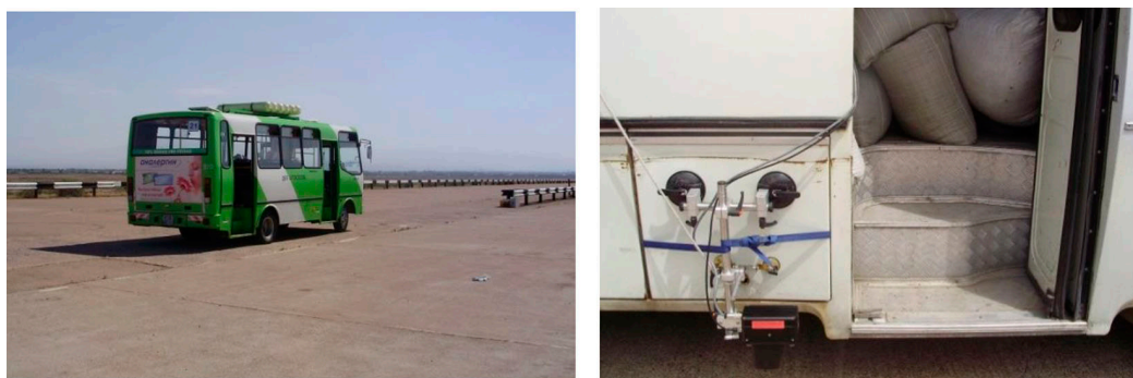
Рис. 1. Фрагменты полигонных испытаний различных газобаллонных автобусов ISUZU SAZ на Пскентском автополигоне
