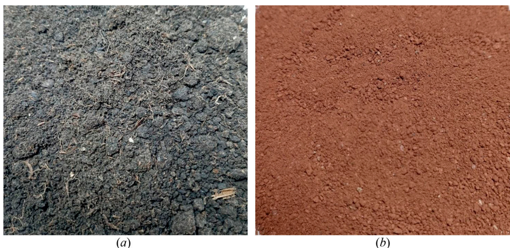
Рис. 2. Сухие иловые остатки сточных вод до (а) и после (б) их озоления.
