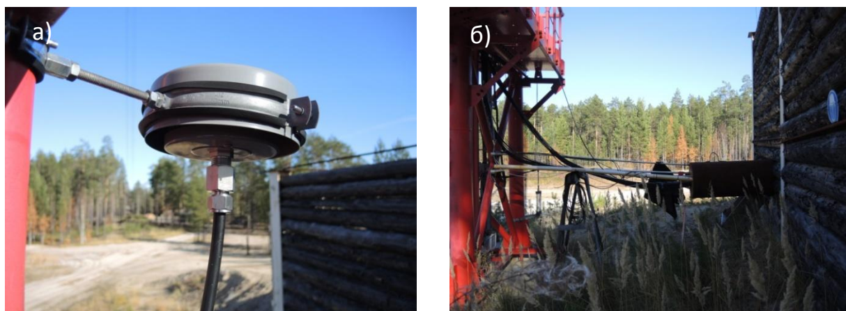
Рисунок 2.5 – Грибовидные воздухозаборники (а) и кольцевидное отверстие бункера (б).
