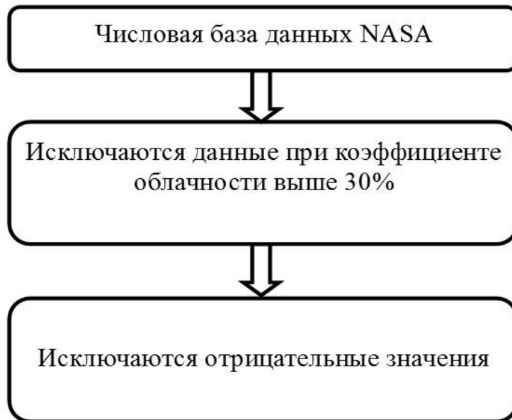
Рисунок 2.3 – Алгоритм обработки числовой базы данных OMI и OMPS
