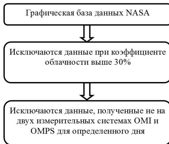
Рисунок 4.3 – Алгоритм обработки графической базы данных NASA
