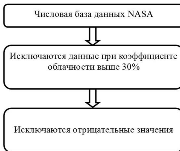
Рисунок 4.2 – Алгоритм обработки числовой базы данных NASA
