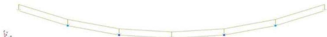
Рисунок 1.15 - Перемещение ванта по оси Z составила в центральном узле 0,528 (м)
