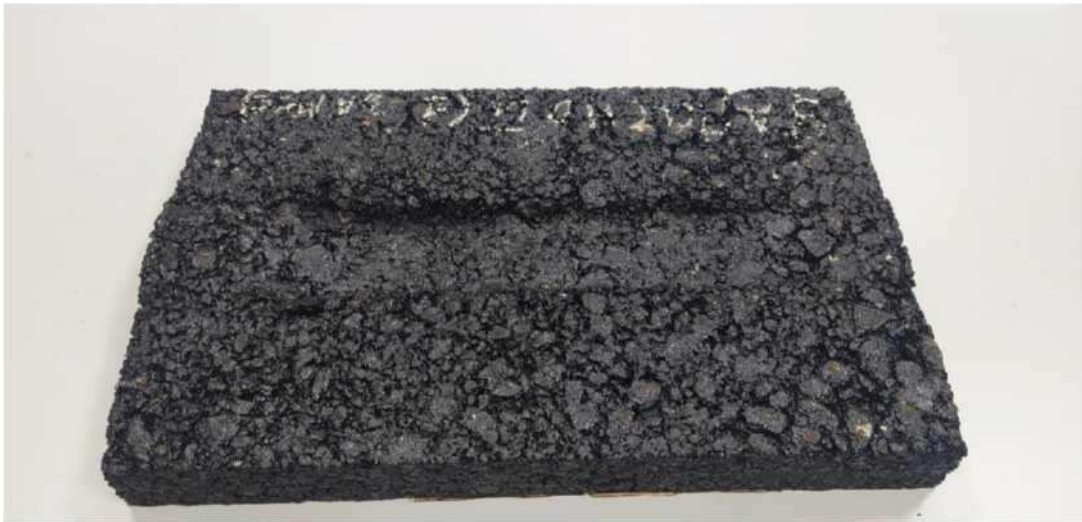
Рисунок 10 - Образец-плита из асфальтобетонной смеси с битумом 4,5% после испытания на колееобразование (вид сверху)
