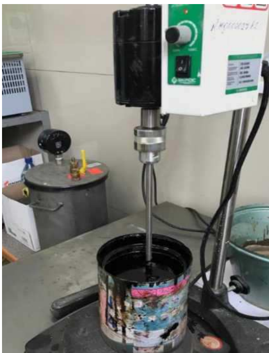
Рисунок 1- Перемешивание битума БНД 90/130 с модификатором «Полиэпор-Р» перемешивающим устройством.
