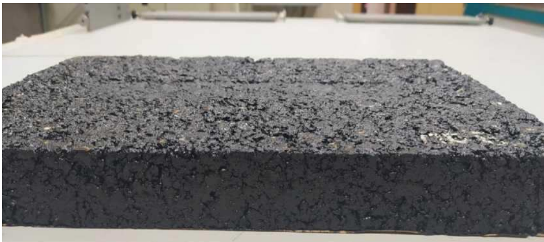
Рисунок 11 - Образец-плита из асфальтобетонной смеси с ПБВ после испытания на колееобразование (вид сбоку)
