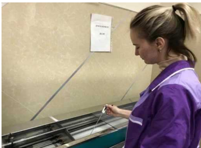
Рисунок 2 - Определение растяжимости вяжущего при помощи дуктилометра.
