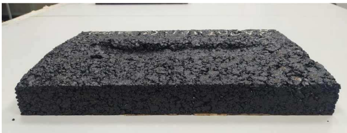
Рисунок 9 - Образец-плита из асфальтобетонной смеси с битумом 4,5% после испытания на колееобразование (вид сбоку)
