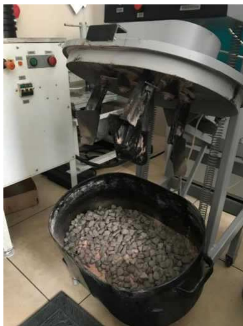
Рисунок 4 - Минеральная часть асфальтобетонной смеси в лабораторном смесителе.
