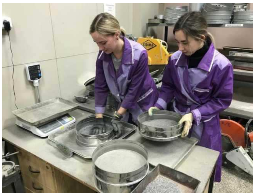
Рисунок 6 - Разделение щебня на фракции методом просеивания
