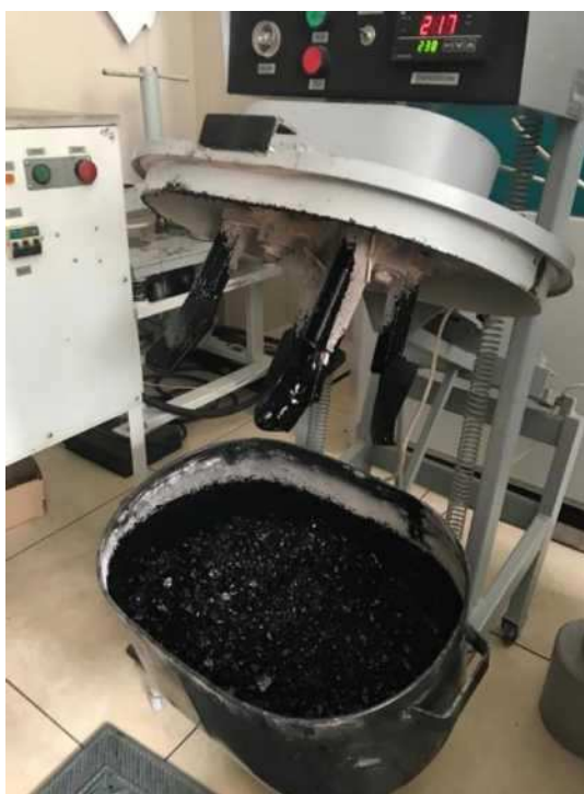
Рисунок 5 - Полученная асфальтобетонная смесь в лабораторном смесителе.
