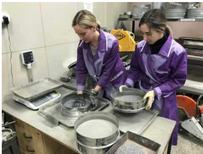
Рисунок 7 - Разделение щебня на фракции методом просеивания
