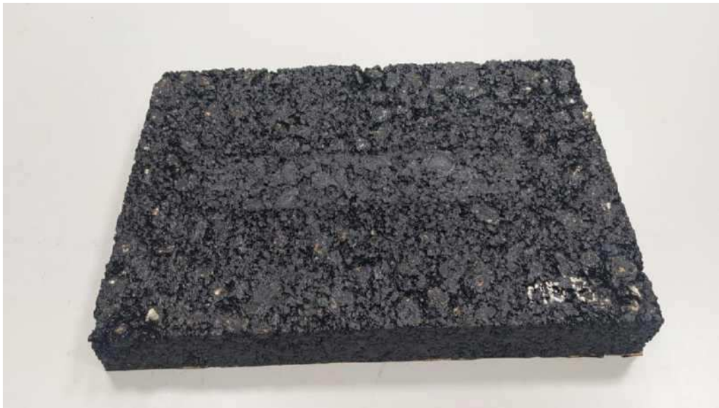
Рисунок 12 - Образец-плита из асфальтобетонной смеси с ПБВ после испытания на колееобразование (вид сверху)
