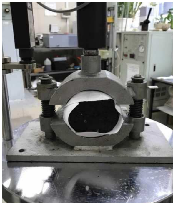
Рисунок 8 - Образец после испытания на определение сдвигоустойчивости по схеме Маршалла
