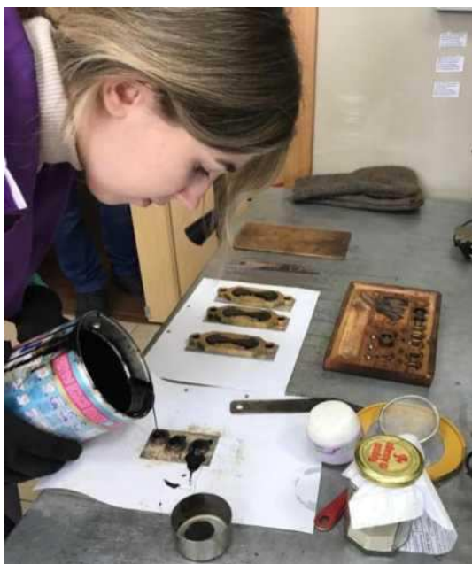
Рисунок 3 - Подготовка образцов вяжущего к проведению испытаний.
