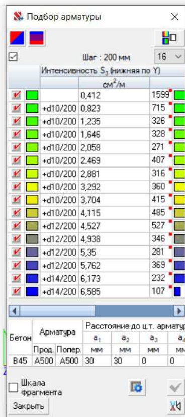
Рисунок 4.27 – Дополнительное нижнее армирование по Y (шаг 200 мм)
