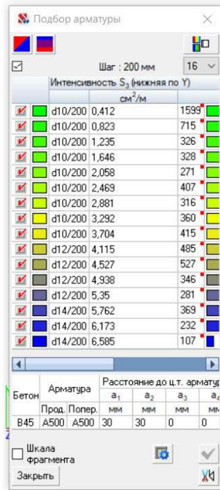
Рисунок 4.26 – Нижнее армирование по Y (шаг 200 мм)
