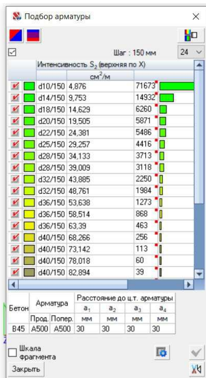
Рисунок 3.13 – Армирование монолитной плиты с интенсивностью S_2 верхняя по х
