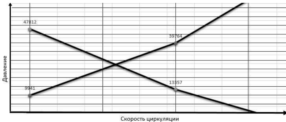
Рисунок 2.15 – Зависимость S_{пол}^k \Delta P_{он} от W_0
