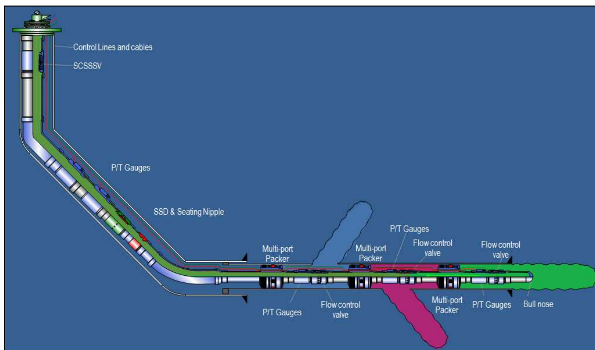
Рис. 3.7 – Схема интеллектуального заканчивания скважин для многозабойной скважины карбонатного месторождения.
