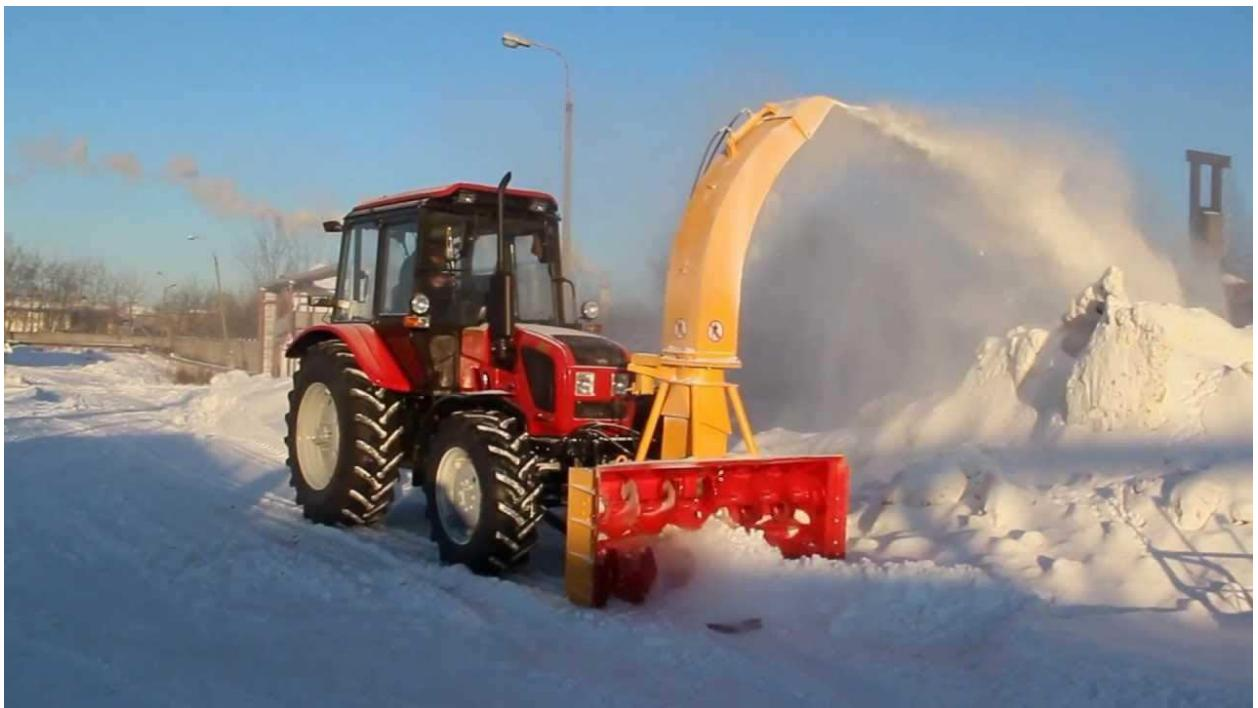
Рисунок 1.4 - Шнекороторный снегоуборочный агрегат
