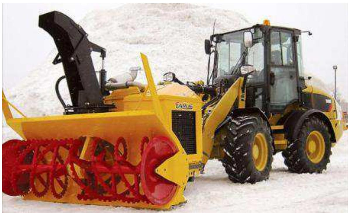
Рисунок 1.3 - Фрезерно-роторное снегоуборочное оборудование
