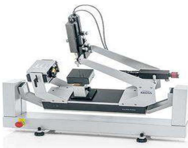
Рисунок 4 – прибор для измерения краевых углов DSA-25E
