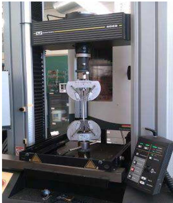
Рисунок 5 – Универсальная испытательная машина Instron 5565-5KN
