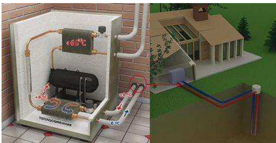
Рисунок 18 – Общий вид теплового насоса
