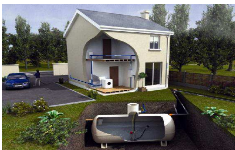
Рисунок 1.21 – Система водоотведения в жилом доме
