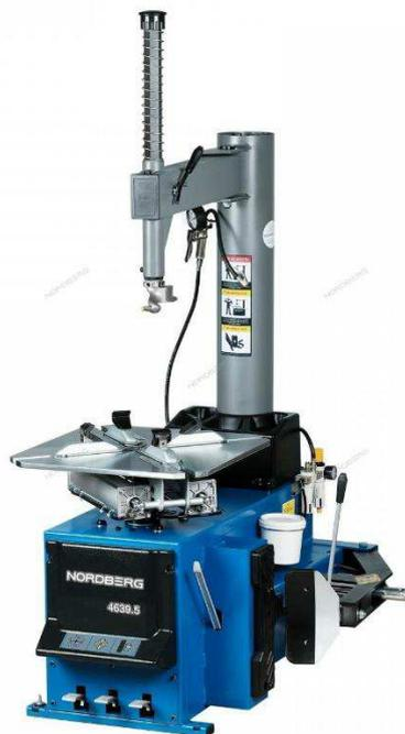
Рисунок 3.3 – Шиномонтажный станок NORDBERG 4639,5
