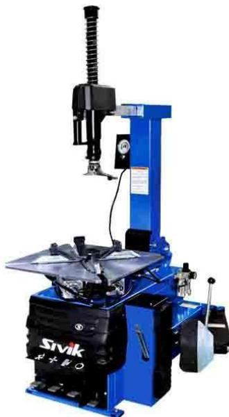
Рисунок 3.4 – Шиномонтажный станок СИВИК КС-402А ПРО
