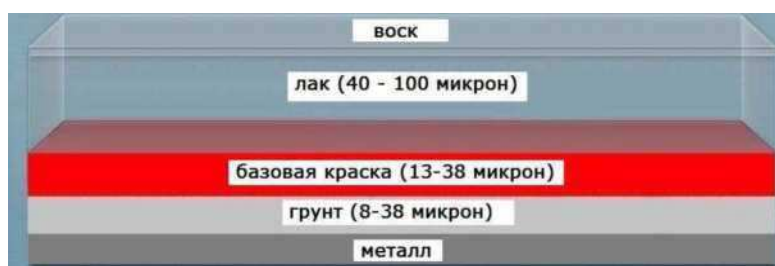
Рисунок 1 - Строение лакокрасочного покрытия
