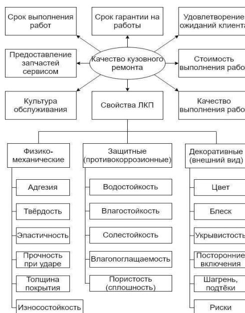
Рисунок 13 – Качество кузовного ремонта
