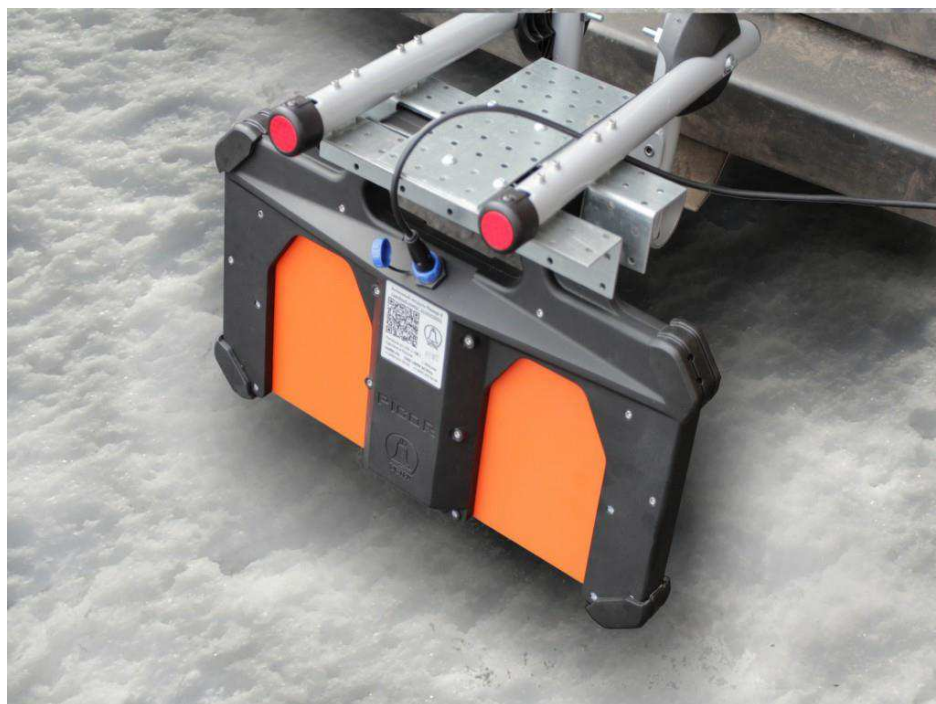
Рисунок 1.9 – Вид контрольно-индикационного прибора «Пикор-Лед»
