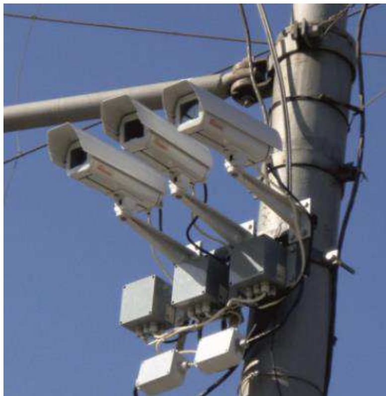
Рисунок 3.1 – Видеофиксатор нарушений Правил дорожного движения ПТИК «Одиссей»
