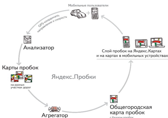
Рисунок 1.9 – Схема работы сервиса «Яндекс.Пробки»
