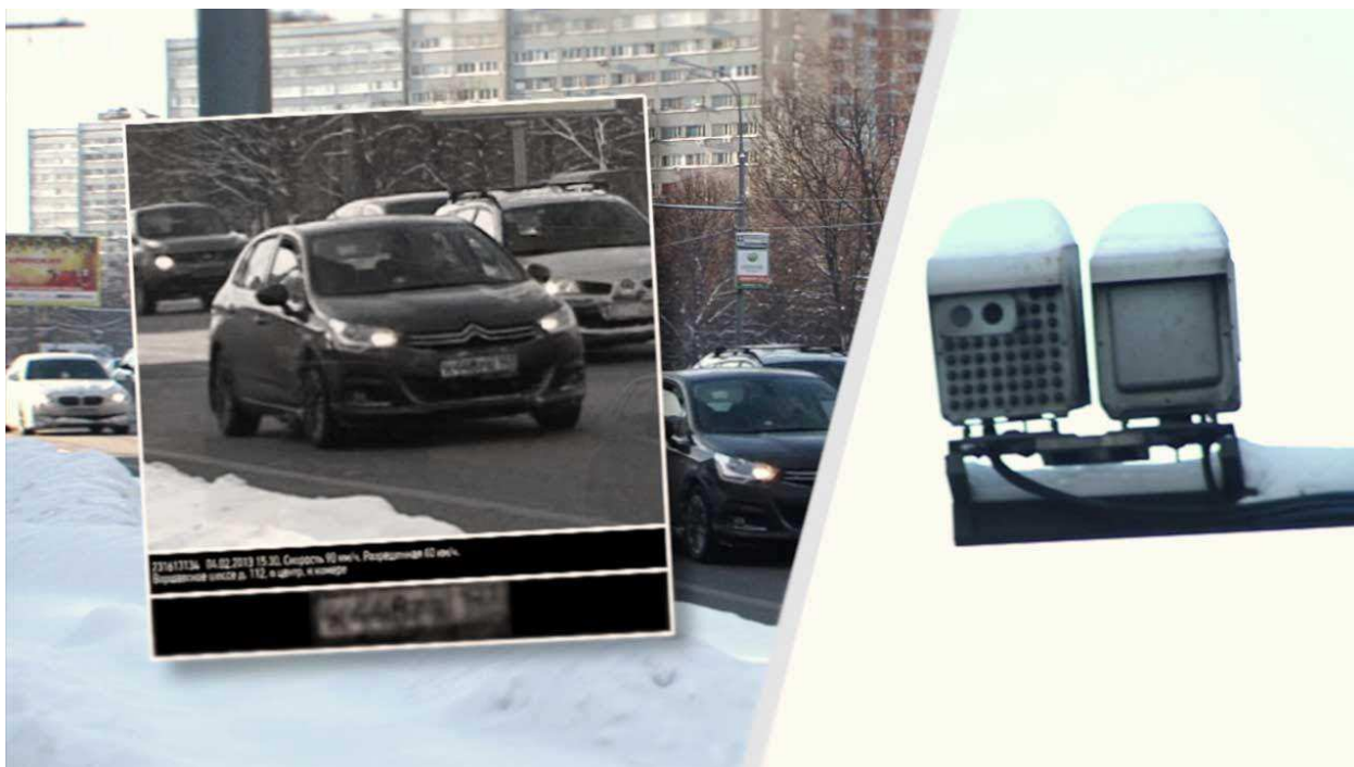
Рисунок 3.2 – Работа автоматического фиксатора правонарушений
