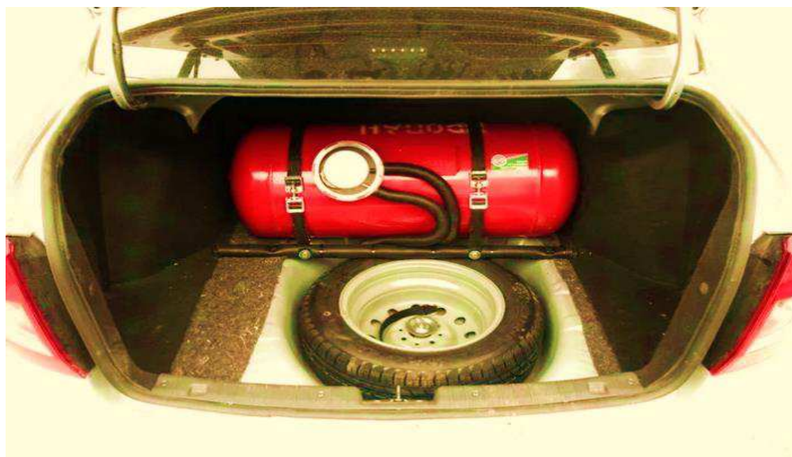
Рисунок 2.9 – Вид установленного газобаллонного оборудования в автомобиле LADA GRANTA
